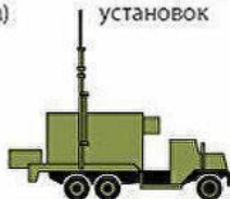
Пункт управления огнем AN/MSQ-104 Обеспечивает управление работой РЛС и пусковых установок
