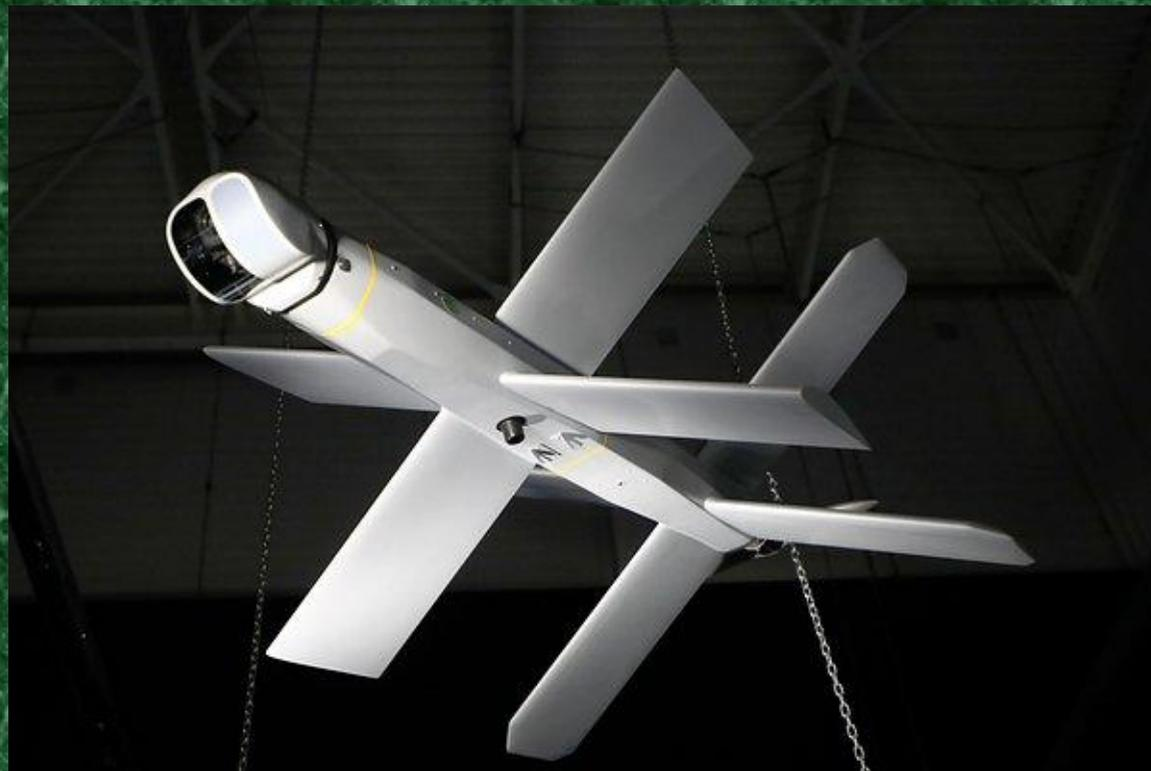
БПЛА «Ланцеты» относятся к такой разновидности беспилотных систем, как барражирующие боеприпасы. Они могут не только обнаружить цель, но и поразить ее встроенной в конструкцию беспилотника боевой частью, которая бывает различного типа и разной мощности.
